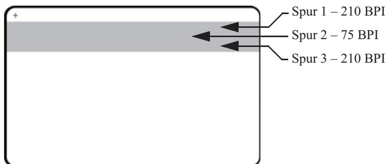
Jede Spur kann mit ASCII-Zeichen in den ISO-Standarddatenformaten codiert und decodiert werden:
