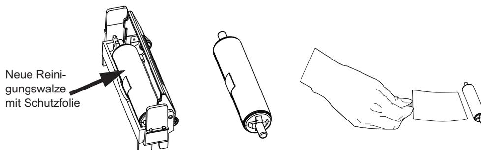
**Schritt 7.** Nehmen Sie die Reinigungswalze aus der Reinigungspatrone, und entfernen Sie dann die Schutzfolie von der Reinigungswalze.
