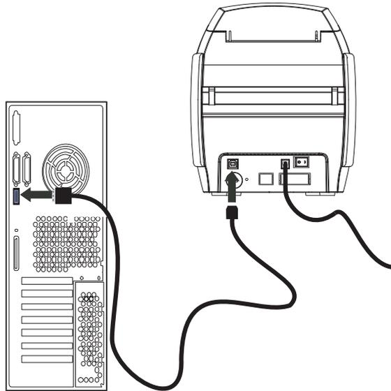
**Schritt 2.** Wenn Ihr Drucker über die optionale Ethernet-Schnittstelle verfügt (zusätzlich zur USB-Schnittstelle), können Sie entweder das USB-Kabel an den Drucker und den Computer anschließen, oder Sie verbinden den Drucker und das Ethernet-Netzwerk mithilfe des Ethernet-Kabels.
