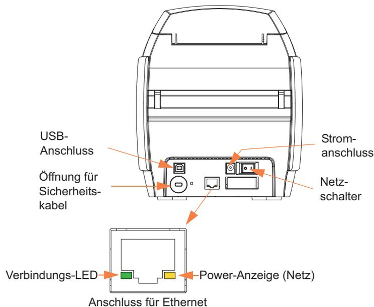
Der Ethernetanschluss verfügt über zwei LED-Statusleuchten:
