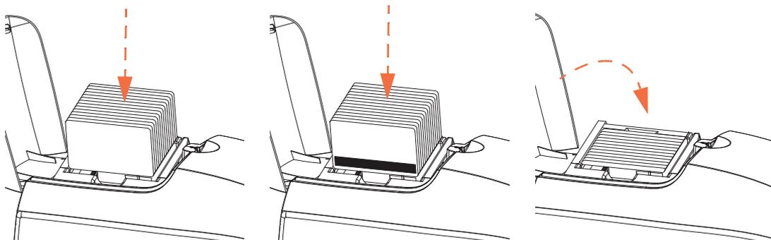
**Schritt 9.** Schließen Sie die Abdeckung des Karteneingabefachs. Beim Schließen der Abdeckung löst sich der Sperrmechanismus der Kartenführung automatisch.
