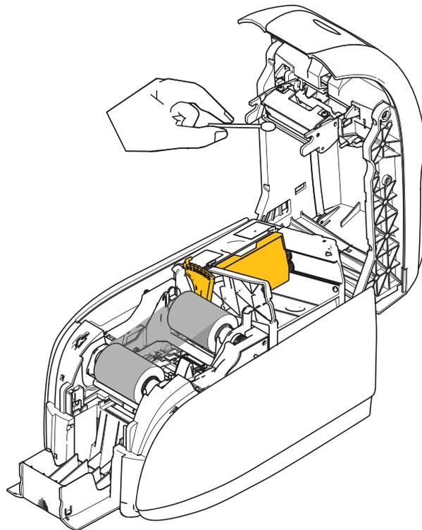
**Schritt 3.** Reinigen Sie den Druckkopf, indem Sie einen alkoholgetränkten Tupfer über die gesamte Fläche der Druckkopfelemente hin- und herbewegen. Üben Sie dabei keinen zu starken Druck aus.
