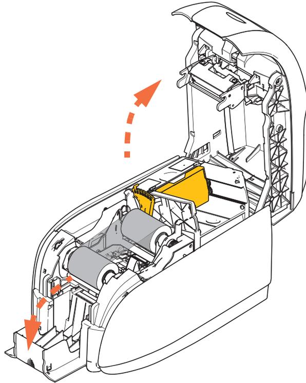
**Schritt 3.** Wenn der Drucker nicht in Betrieb ist, sollten Sie das Kartenausgabefach schließen, um den Drucker vor Staub zu schützen.
