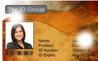
Unregelmäßige Fehlstellen im Druckbild
